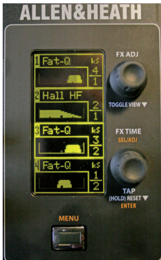
Fig. 4 – Display LCD e potenziometri di controllo effetti
